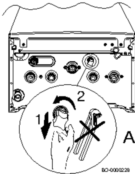
SI.10 Punjenje instalacije
