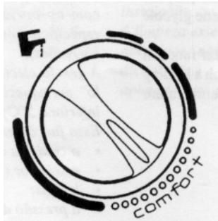
Prilikom rada vrši električnu modulaciju plamena u zavisnosti od zadate temperature sanitarne vode. Sa modulacijom plamena omogućeno je relativno konstantna temperatura tople vode i kod malih protoka. Radi štednje energije preporučuje se da dugme br.6 bude na poziciji „comfort“.
